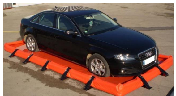
Les mousses s'écrasent et se reforment après passage du véhicule. Les bords remontent au fur et à mesure du remplissage et les plaques de renfort se positionnent automatiquement.
